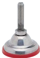
Part. R0384 - Pág. R56 Ø 65 • Acero inox • Esterilizable • Carga max. 12000 N.
