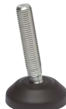
Part. R0098 - Pàg. R14 - R15 Ø 60 • Carga max. 12000 N.
