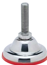
Part. R0399 - Pág. R56 Ø 90 • Acero inox • Esterilizable • Carga max. 11000 N.
